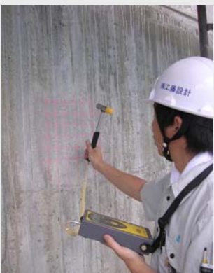
コンクリートテスターによる強度推定
